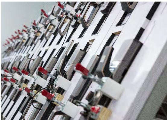
罗漫斯全自动智能锁从生产到出厂需经过以下测试内容：智能锁撞击测试、耐压测试、锁芯防钻测试、硬度测试、整锁寿命测试、把手开合测试、高温测试以及盐雾测试等。
